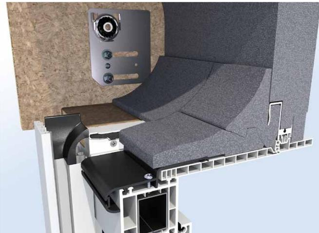
Variante 1 mit verstellbarer Lagerplatte
