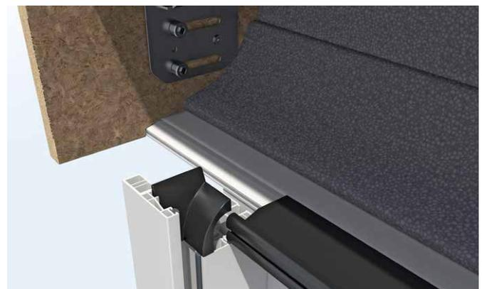
Detail: Einlauf RG mit abgesetzter Führungsschiene und Einlauftrichter offen
