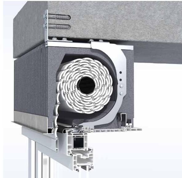
Detail: Befestigung von außen, Verstärkungskonsole mit Winkel
