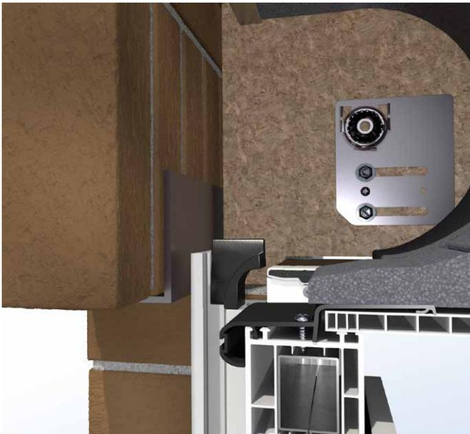
Einbausituation Neubau-Auflagerkasten RUI Variante 1 – Führungsschiene ausgeklinkt mit halbem Trichter (Standard)
