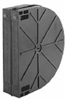
Kunststoff- Mauerkasten 16,5er: 45 x 185 x 170 mm 18,5er: 45 x 202 x 234 mm (Maßangabe B x H x T)
