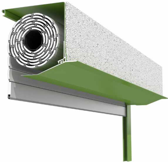
Abgeschrägt 20° (Standard), Kasten rollgeformt, Revision unten, Darstellung ohne Hinterblende
