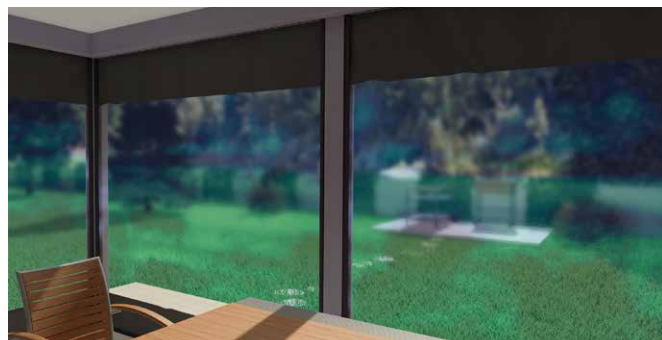
Eintrübung/blauer Schimmer aufgrund von Feuchte – Sichtfenster läuft waagrecht durch bis zur Führungsschiene (im Bereich des Sichtfenster ist senkrecht kein Tuch mehr).
