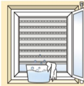
Wir empfehlen Kunststoffreiniger für Hart-PVC. Bitte verwenden Sie keine lösungsmittelhaltigen oder körnige Reiniger. Wichtig ist die Nachbehandlung mit einem Antistatikum.
